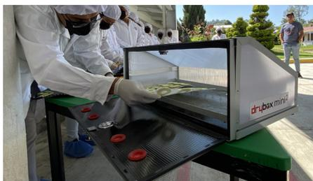
*Fig 1. fotografía de un secador solar directo tipo invernadero utilizado para capacitación con los productores de Hueyapan, Morelos*
