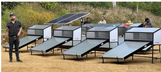
*Fig 2. fotografía de 4 secadores solares tipo gabinete mixto instalados en el Centro Comunitario para el secado solar de alimentos de Hueyapan, Morelos*
