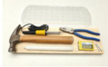
g. Como opción 1, se pueden perforar los puntos marcados sobre la tapa transparente utilizando un martillo y clavo.
