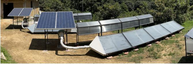
*Fig 3. fotografía de 2 secadores solares tipo túnel autónomos con panel fotovoltaico para accionar el ventilador. Sistemas instalados en el Centro Comunitario para el secado solar de alimentos de Hueyapan, Morelos*
